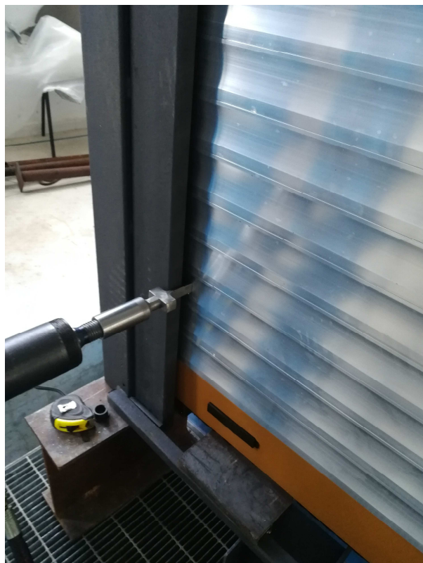
Foto 4 e Foto 5. Campione sottoposto a prova -applicazione dei carichi statici F1-prova statica su guida e chiusura (sx)- sottoposto a prova dinamica (dx)
