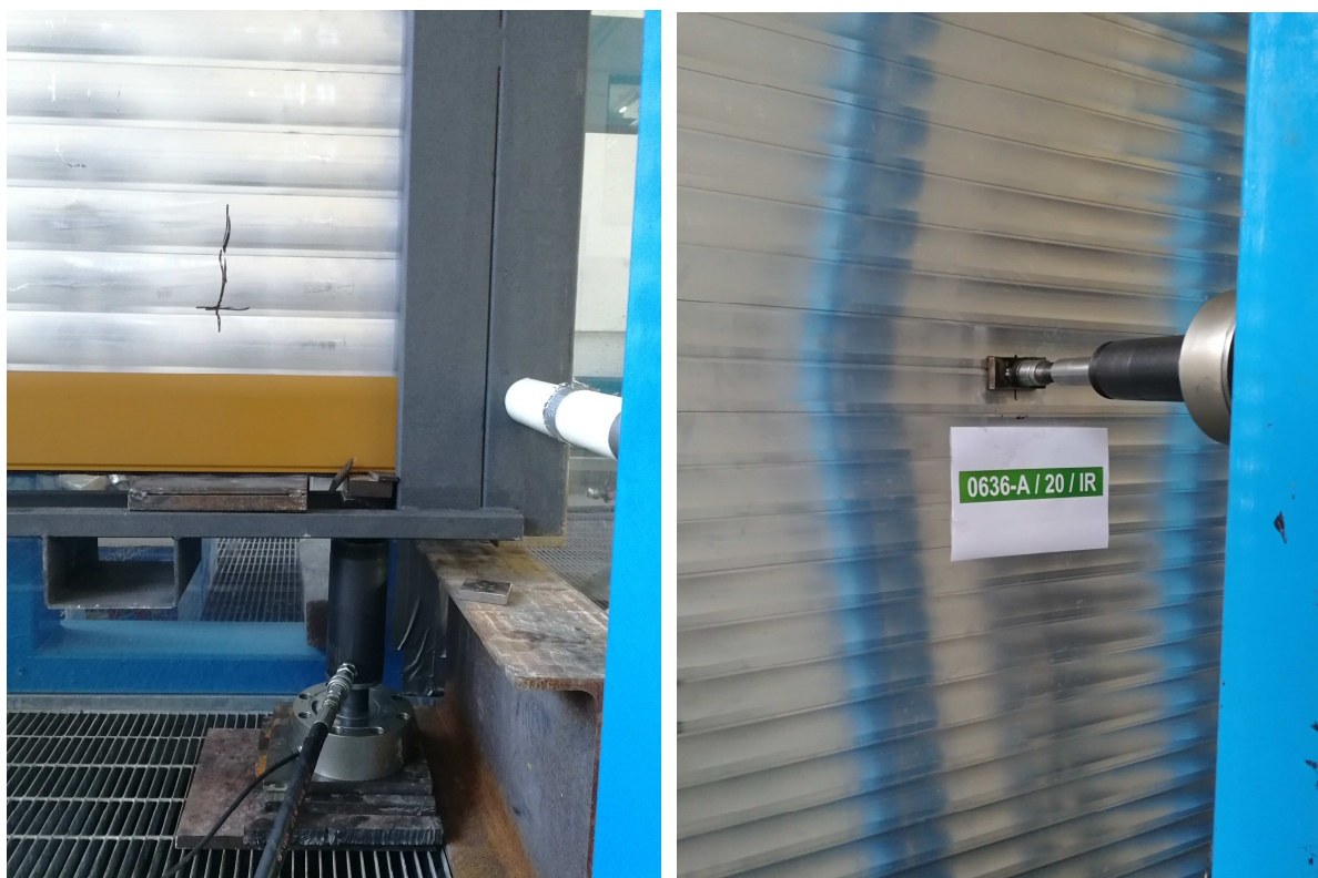
Foto 2 e Foto 3. Campione sottoposto a prova -applicazione dei carichi statici F3-prova di sollevamento della chiusura (sx)- applicazione dei carichi statici F2 – prova di innesto delle doghe (dx)
