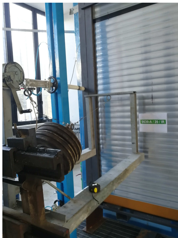
Foto 4 e Foto 5. Campione sottoposto a prova -applicazione dei carichi statici F1-prova statica su guida e chiusura (sx)- sottoposto a prova dinamica (dx)
