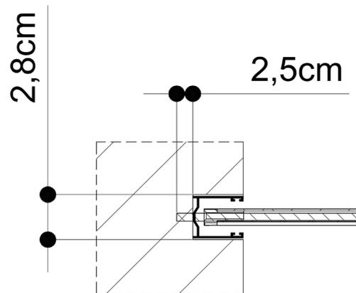
Fissare le guide in bolla, con viti e/o tasselli (non inclusi) adatti alla muratura ad un interasse di almeno 50 cm. Evitare il serraggio eccessivo, al fine di prevenire deformazioni delle guide e conseguenti malfunzionamenti (Fig. A e B).
