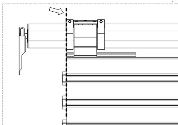
Il posizionamento dei blocchi di sicurezza va effettuato montando l'anello più esterno in modo da sovrapporsi con l'estremità della fascia d'alluminio.
